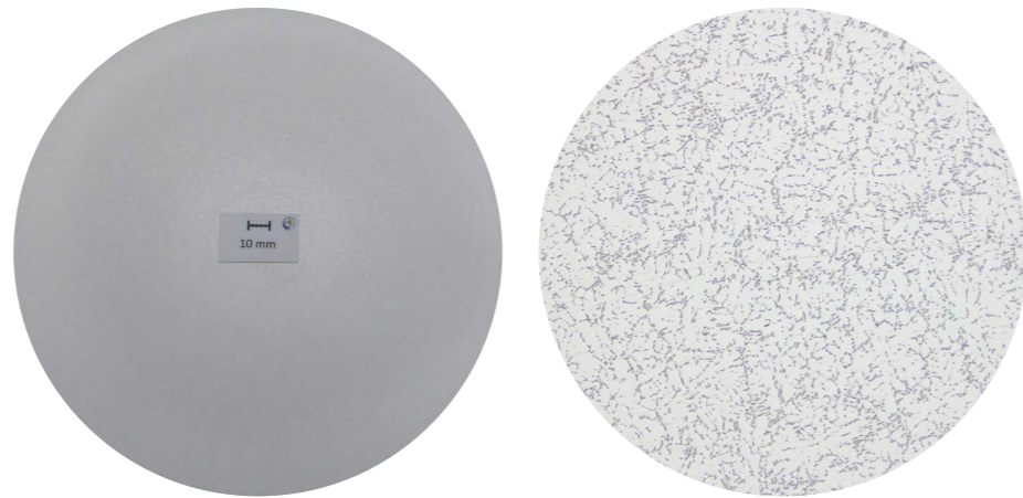
Makroschliff, d252 mm: Seigerungszone 3,1 mm Mikroschliff, d252 mm (25 fache Vergrößerung)
