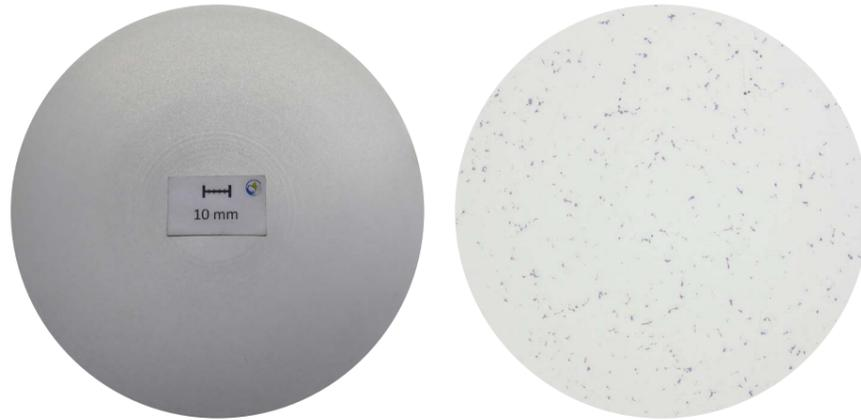
Makroschliff, d177 mm: Seigerungszone 3,1 mm      Mikroschliff, d177 mm (25 fache Vergrößerung)
